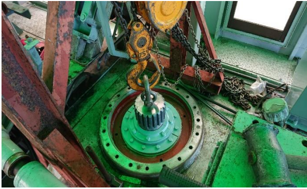
原動滑車軸オーバーホール ゴムライナー更新
